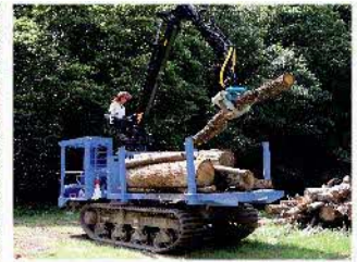
高性能林業機械(フォワーダ)操作
